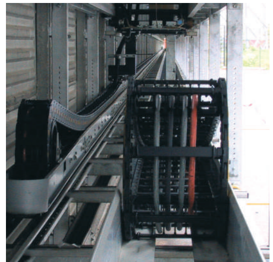
Versuchsanlage für lange Verfahrswege: Geschwindigkeit 8 m/s; Verfahrsweg 130 m
