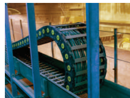
Energieführungs-kette aus Kunststoff vom Typ MSO, Einsatz in der Müllverbrennungsanlage "Vestforbrænding" in Dänemark
