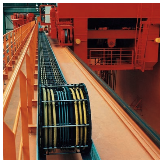
Catena tipo 318 per corse lunghe installata su carroponete.
