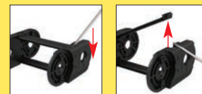
Come sganciare il perno di giunzione.
