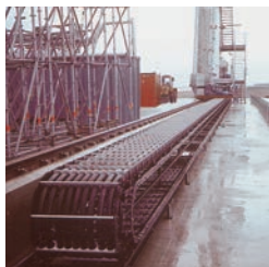
5 Catene 35 dotate di carro mobile applicate su impianto di De Icing presso l'aeroporto di Monaco di Baviera D. Lunghezza corsa m. 90 Velocità di scorrimento m 90 al minuto.
