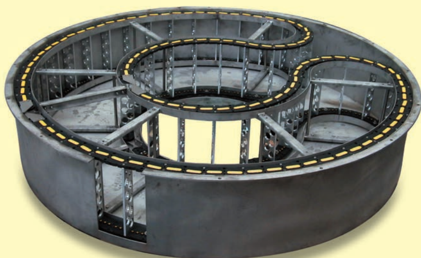
Rotazione in piano con due catene. Rotazione 370°.
