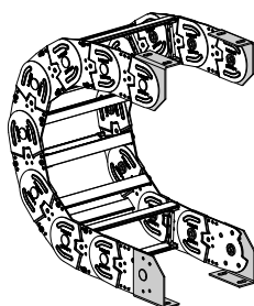
Fig. A Fissaggio della catena sull'esterno raggio. (Fig A) Vedi varianti di montaggio a pag. 31
