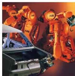
Schweißarbeiten mit einer rotierenden Energieführungs-kette am Fließband.
