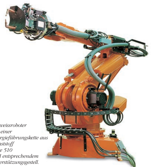
Schweißarbeiten mit einer rotierenden Energieführungs-kette am Fließband.
