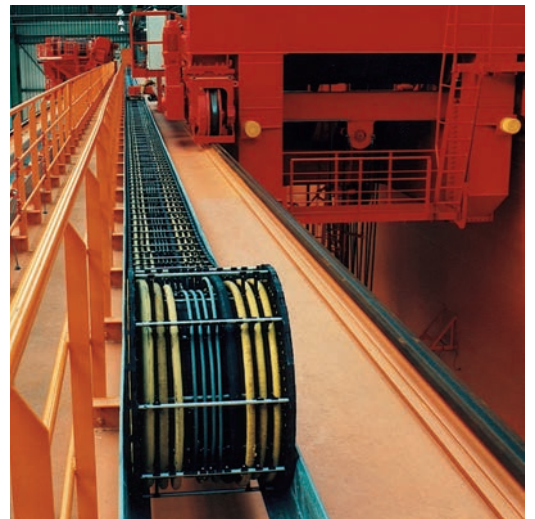
Energieführungs-kette Serie 318 für lange Verfahrwege an einem Kran.
