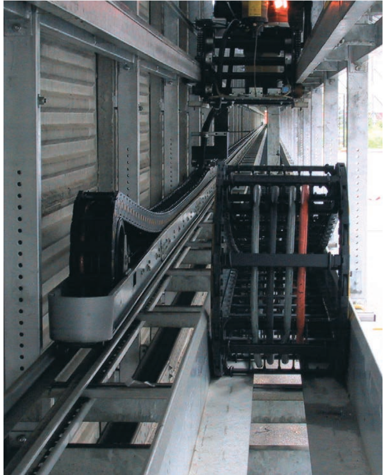
Versuchsanlage für lange Verfahrswege: Geschwindigkeit 8 m/s; Verfahrsweg 130 m
